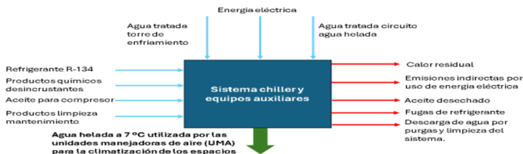
Fig. 1. Entradas y salidas del sistema Chiller.
