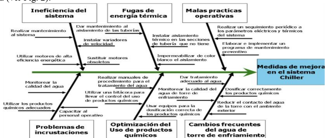
Fig. 2. Medidas de Producción más Limpia (P+L) identificadas en el sistema chiller.
