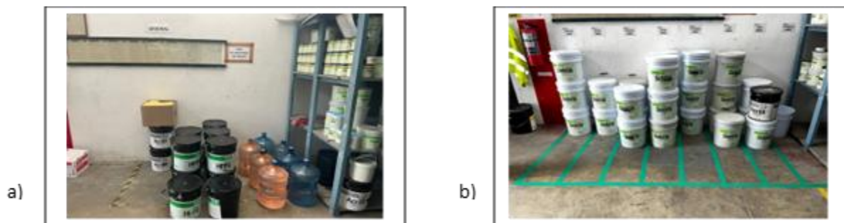
Fig. 1. Aplicación de 5S en almacenamiento: (a) antes, área desordenada; (b) después, espacios delimitados y organizados.
