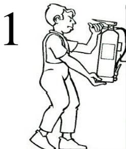
**1.** Descolgar el extintor asiéndolo por la maneta o asa fija y dejarlo sobre el suelo en posición vertical.
