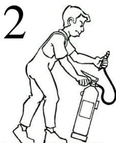
**2.** Sacar la boquilla de la manguera del extintor y sacar el pasador de seguridad tirando de su anilla.
