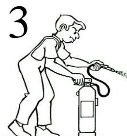
**3.** Presionar la palanca de la cabeza del extintor y en caso de que exista apretar la palanca de la boquilla realizando una pequeña descarga de comprobación.
