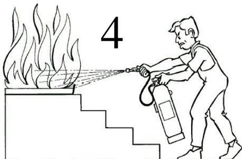
**4.** Dirigir el chorro a la base de las llamas con movimiento de barrido. En caso de incendio de líquidos proyectar superficialmente el agente extintor efectuando un barrido evitando que la propia presión de impulsión provoque derrame del líquido incendiado. Aproximarse lentamente al fuego hasta un máximo aproximado de un metro
