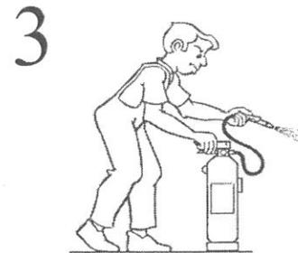
**3.** Presionar la palanca de la cabeza del extintor y en caso de que exista apretar la palanca de la boquilla realizando una pequeña descarga de comprobación.
