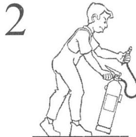
**2.** Sacar la boquilla de la manguera del extintor y sacar el pasador de seguridad tirando de su anilla.
