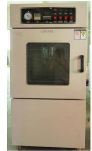
Se sometió a un proceso de curado en una estufa con vacío
