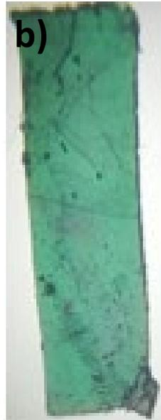
Membrana impregnada de ditizona después de ser sumergida en solución acuosa en presencia de plomo
